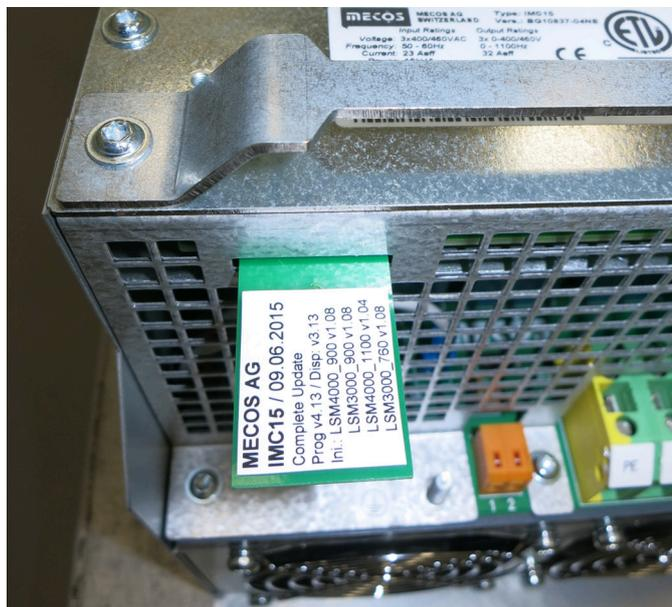
Abbildung 11: eingesteckte Flash-Karte
